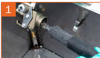
Limpieza del conducto de pintura
