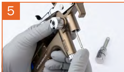
Montaje de la aguja de pintura
