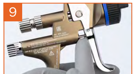
Engrasar el área visible del vástago del pistón de aire
