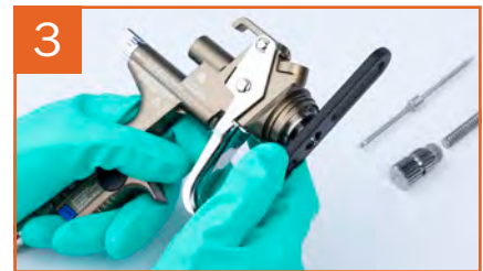
Desatornillar la boquilla de pintura con la llave de anillo integrada en la herramienta universal
